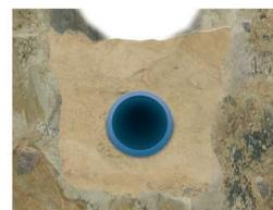
Pose en tranchée ouverte avec enrobage de sable
