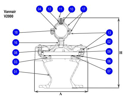
La ventouse "Vannair" se compose d'un corps et, selon le modèle, d'un robinet d'arrêt. Ce corps se termine par un évasement contenant une boule flottante entièrement revêtue d'élastomère, ainsi qu'un disque flottant sur lequel sont insérés deux joints toriques concentriques. Le mouvement de la boule et du disque est guidé verticalement, permettant de dégager ou de fermer respectivement l'orifice de dégazage ainsi que la couronne d'ouvertures de la plaque supérieure (plaque à trous).
