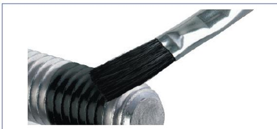
**5** Une fois la pièce assemblée, les filetages des boulons / tiges doivent être enduits d'une graisse imperméable à base de graphite pour prévenir la corrosion et faciliter les opérations de démontages ultérieures.
