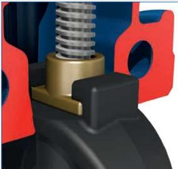
02 : Notre conception autour d'un écrou libre permet, lors de la manœuvre, son auto centrage dans l'opercule. Ce qui **minimise** ainsi **les efforts de flexion sur la tige de manœuvre** et garantit la pérennité du système.
