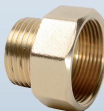
Réduction mâle /femelle à épaulement répondant au montage de deux pièces dont le filetage à un écart de 1 à 2 Ø nominaux. Fileté du 1/4" au 1"1/2 et taraudé du 3/8" au 2".
