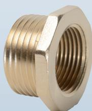
Réduction concentrique mâle / femelle convenant à tout type de montage de deux pièces réduisant de plusieurs crans le Ø nominal. Fileté du 1/4" au 2" et taraudé du 1/8" au 1"1/2.
