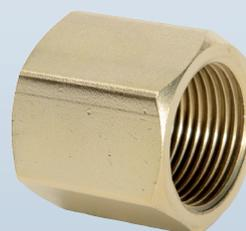
Pièce qui permet de raccorder deux pièces mâles égales ou inégales au pas du gaz y compris de type about fileté avec épaulement. L'étanchéité étant assurée par apport de matière comme ruban ou cordon en PTFE.
