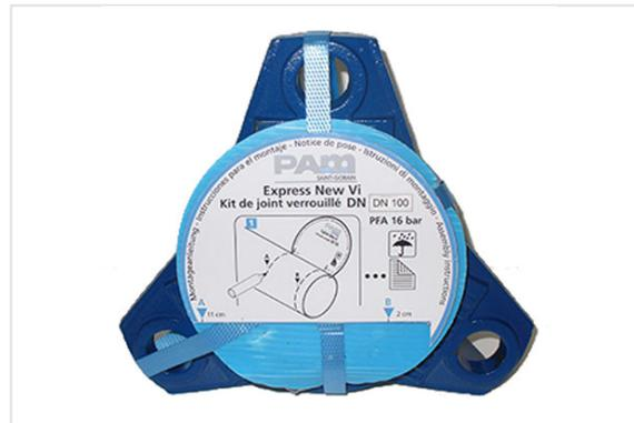
Le joint Express New Vi est un joint mécanique. L'étanchéité et le verrouillage sont assurés par la compression axiale d'une bague de joint en élastomère à inserts métalliques, au moyen d'une contrebride serrée par des boulons en fonte et rondelles acier.
