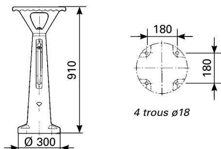
Pour robinet-vannes à obturateur DN 40 à 200 - PFA16 - FSH/FSIH
