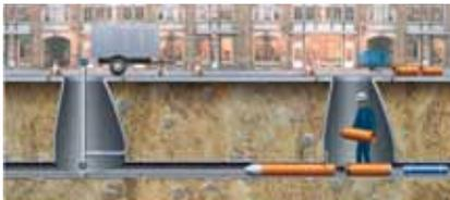
Retubage avec insertion module par module
