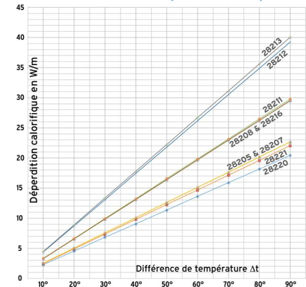
DOUBLE CHAUFFAGE - déperditions calorifiques 1
