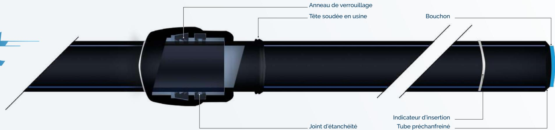
**Solution spécialement conçue pour s'adapter aux contraintes des chantiers en milieu difficile :**
