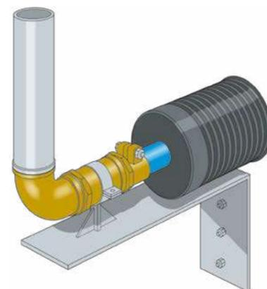
o La gamme complète d'accessoires en laiton tels que manchons, coudes, raccords en té, etc. permet, en combinaison avec les raccords d'extrémité sur PER-a, de créer toutes les configurations de raccordement et dimensionnelles possibles.
