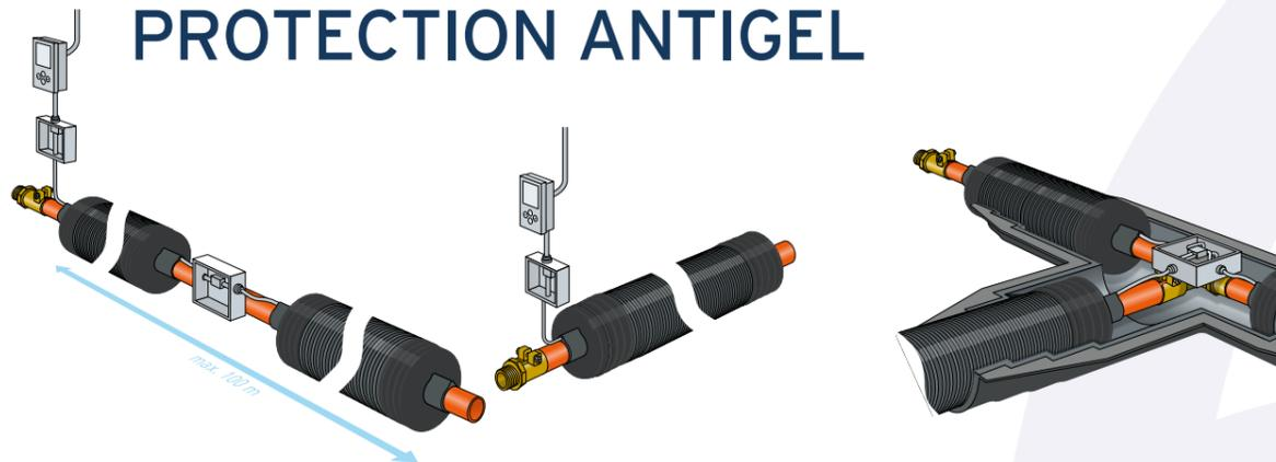
Notre canalisation pré-isolée avec protection antigel est équipée d'un cordon chauffant autorégulant de 10W/m positionné le long du tube qui protège les eaux stagnantes du gel. Le cordon chauffant doit être raccordé au réseau électrique en 220V/50 hertz.
