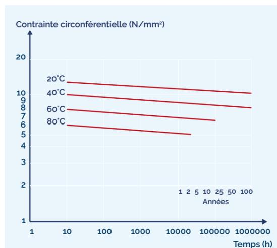
Les courbes de régression, issues d'essais de vieillissement accéléré et corrélées par des prélèvements sur des canalisations en fonctionnement, permettent d'extrapoler les performances des tubes en polyéthylène sur le long terme.
