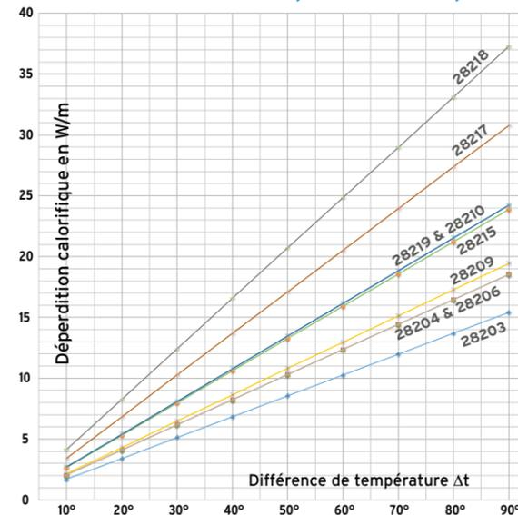
SIMPLE CHAUFFAGE - déperditions calorifiques 2
