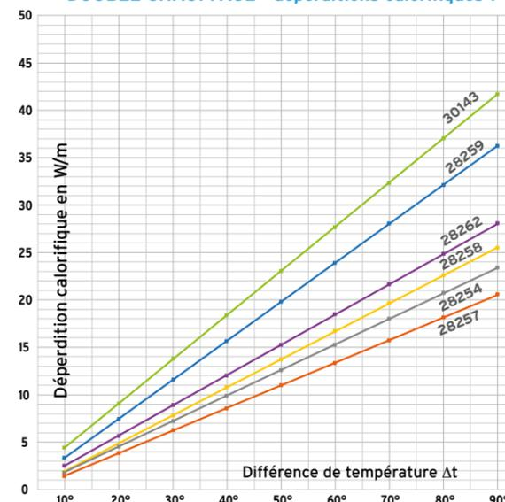
DOUBLE CHAUFFAGE - déperditions calorifiques 2
