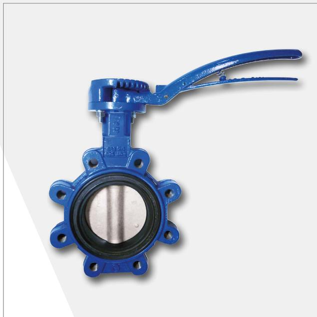
Vannes à papillon type Sylax, oreilles taraudées, papillon inox, manchette EPDM avec poignée crantée fonte, corps fonte GS
