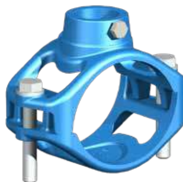
Montage pour canalisation rigide L'inversion d'une des 2 demi-bridés libère la fonction butée
