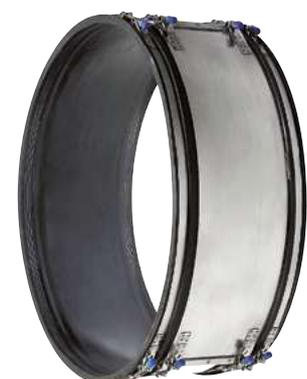
(3) Pour des montages sur tuyaux flexibles (type PEHD annelés, par exemple) le couple de serrage peut être porté à 20-22 Nm au lieu des 17 Nm spécifiés sur l'étiquette du raccord.
