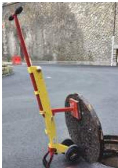
LE MANIPULATEUR est composé d'un assemblage mécanique, il est pourvu d'un aimant puissant permettant la préhension ferme des plaques télécom et tampons de voirie. Cet outil s'adresse à tous les intervenants des réseaux secs et humides. Il peut être équipé d'élargisseurs de roue adaptés aux grandes sections de plaques. Conçu avec l'aide des utilisateurs et le soutien des institutions liées à la santé du travail, il offre les avantages suivants :
