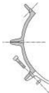
Les colliers de centrage MA sont composés de plusieurs segments assemblés par boulonnerie zinguée.
