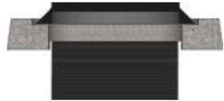
La dalle de répartition + le tampon fonte D400 permettront d'effectuer un réglage supplémentaire de +100 à +200mm
