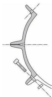
Les colliers de centrage MA sont composés de plusieurs segments assemblés par boulonnerie zinguée.
