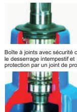
Boîte à joints avec sécurité contre le desserrage intempêstif et protection par un joint de propreté
