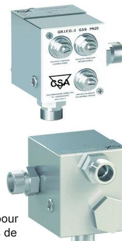
Le pilote CSA avec filtre incorporé GR.I.F.O. a été conçu pour améliorer la stabilité et la précision du débit sur les vannes de régulation hydrauliques CSA série XLC grâce à une combinaison de vannes à pointeau réglables et clapets anti-retour. Entièrement construit en acier inoxydable, insensible à la corrosion, compact et muni de plusieurs ports de pression.
